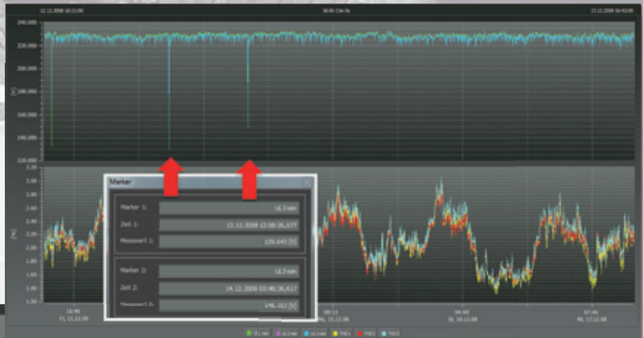
Valeurs extrêmes de tension et de courant horodatées à la milliseconde
