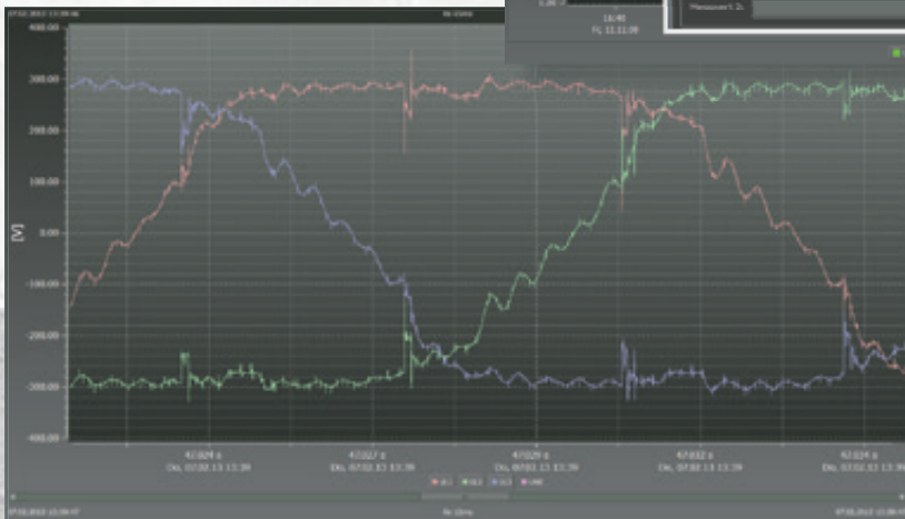
Oscillo-perturbographe – Niveau de résolution extrêmement élevé grâce à l'intégration de convertisseur A/D 24 bit à chacune des entrées de tension et de courant.
